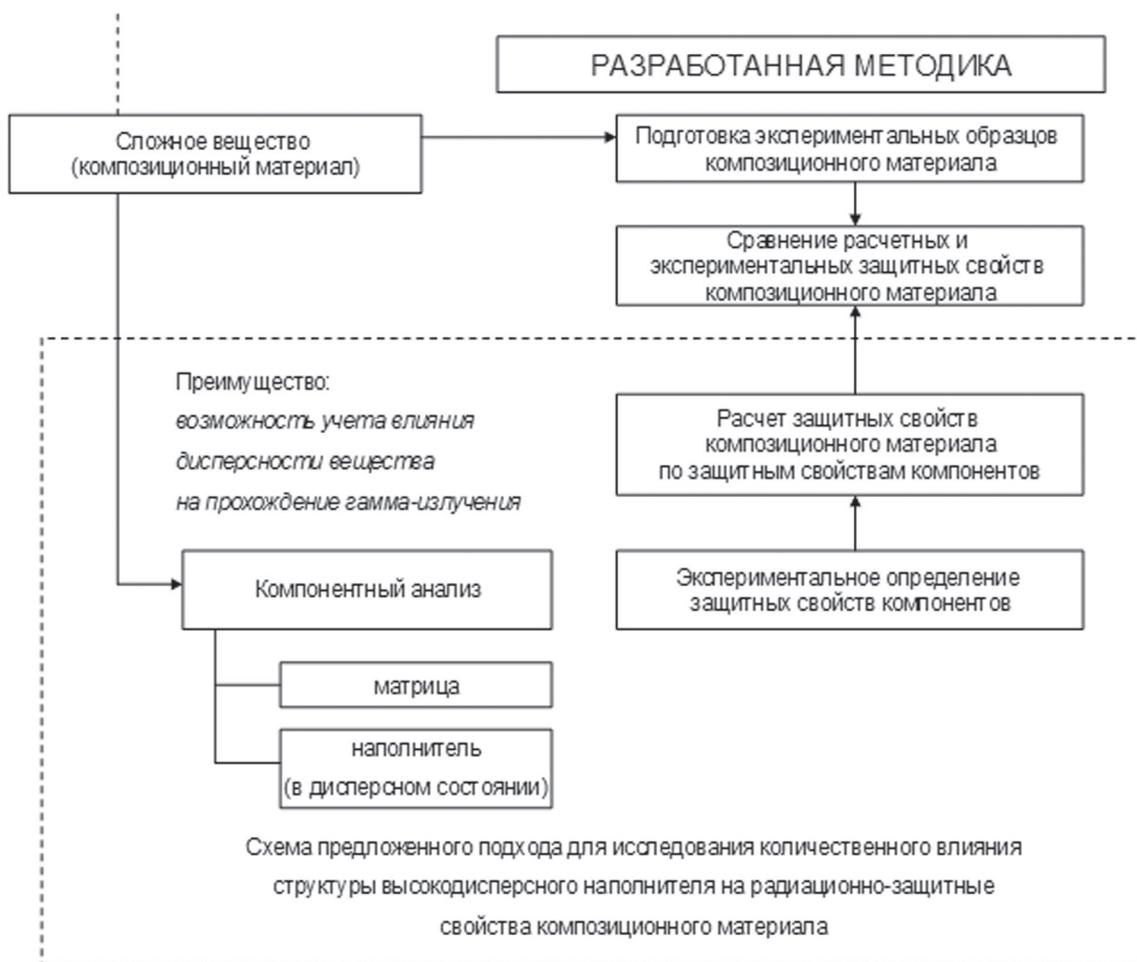
Рис. 1. Методика разработки радиационно-защитных материалов
