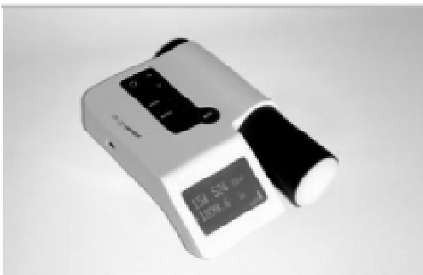
Рис. 3. Прилад для контролю якості моніторів та негатоскопів
